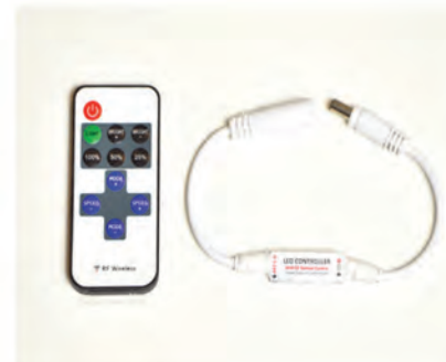
40203 Mini Dimmer III with RF remote 12V 24 watts
