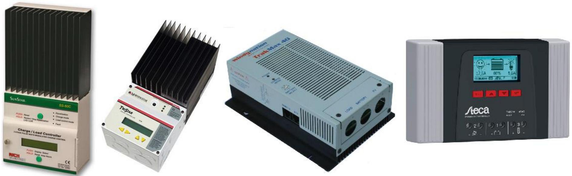
El **controlador de carga** es el corazón de los sistemas fotovoltaicos que utilizan baterías. El controlador de carga controla como se cargan las baterías regulando el voltaje y la corriente DC que proviene del arreglo de módulos fotovoltaicos ("*paneles solares*").
